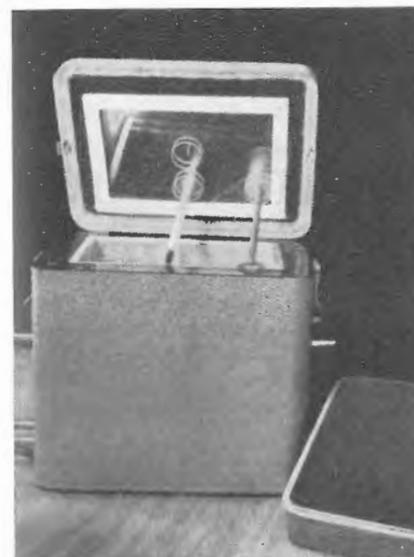
Fig. 22 Realizzazione pratica di un contenitore termostatico.
